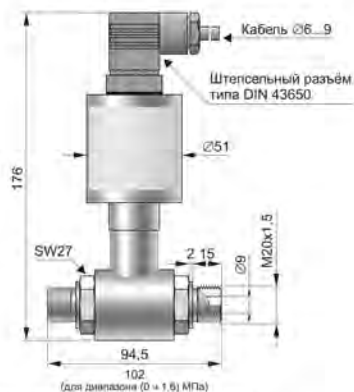
Преобразователь исполнения PD Пример со штуцерами типа P Допустимое статическое давление 4 МПа
