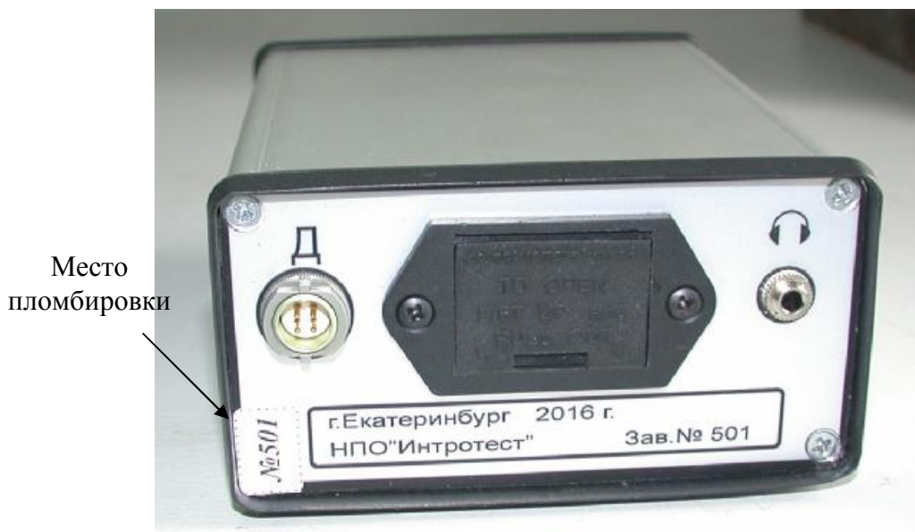
Рисунок 2 – Схема пломбировки электронного блока дефектоскопа вихретокового ВИТ-4
