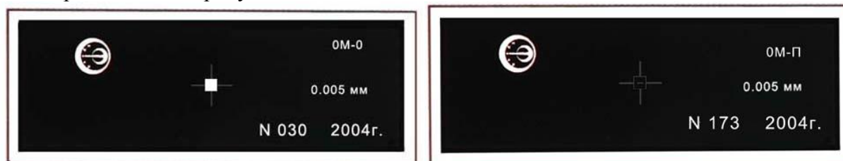
Рисунок 1 - Внешний вид ОМ (слева - Объект-микрометр ОМ-О, справа - Объект-микрометр ОМ-П)
