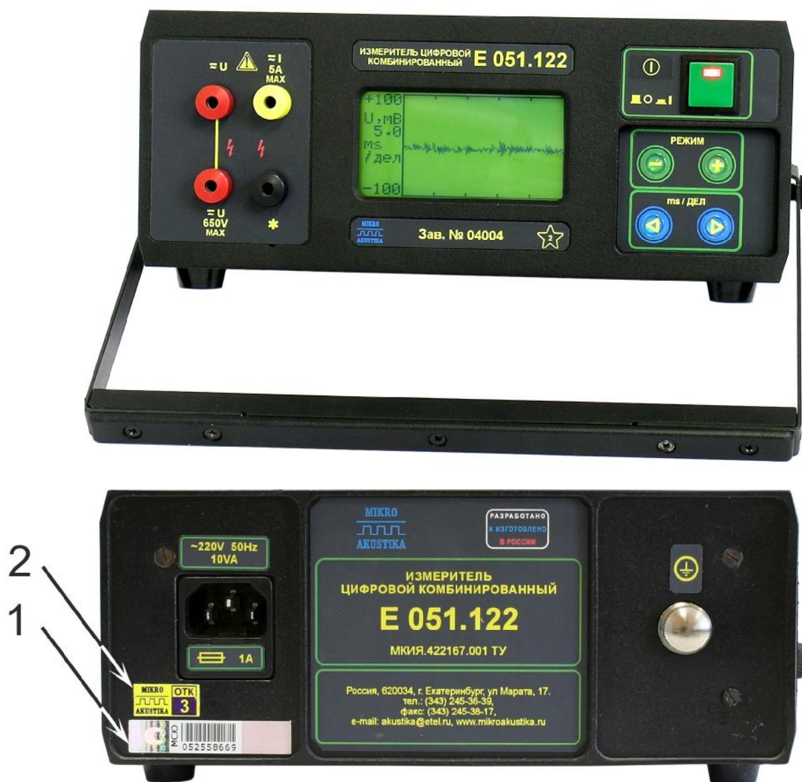
Рисунок 1. Внешний вид измерителя. Стрелками указаны: 1 – место нанесения поверительного клейма в виде наклейки; 2 – место заводского пломбирования.
