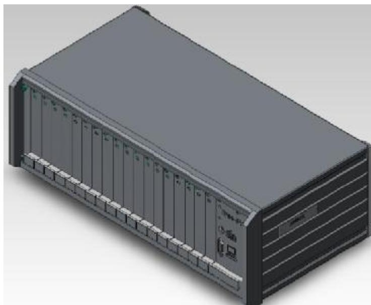
Рисунок 1 - Внешний вид преобразователя многоканального измерительного сигналов рельсовых цепей ПМИ-РЦ.
