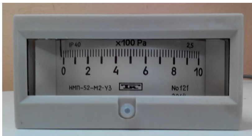
Рисунок 1 - Общий вид тягомеров, напоромеров, тягонапоромеров мембранных показывающих ТММП-52-М2, НМП-52-М2, ТНМП-52М2 с местом пломбирования
