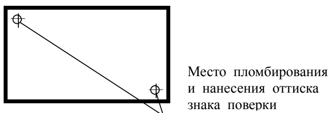
Рисунок 2 — Схема пломбировки прибора
