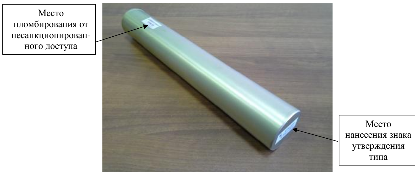
Рисунок 2 - схема пломбировки блоков детектирования БДИГ-31П2 от несанкционированного доступа
