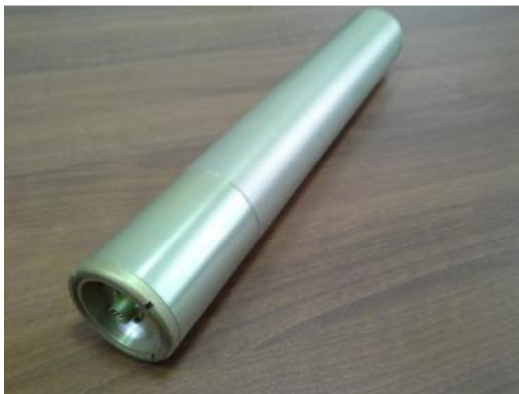
Рисунок 1 – Внешний вид блока детектирования БДИГ-31П2
