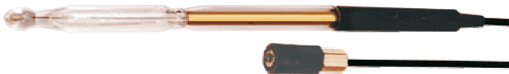
Рисунок 2 – Общий вид электрода стеклянного лабораторного ЭСЛ-51-07СР
