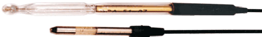
Рисунок 1 – Общий вид электрода стеклянного лабораторного ЭСЛ-51-07
