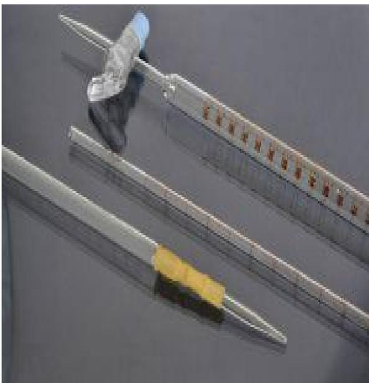
Бюретки представляют собой стеклянные трубки с измерительной шкалой. Верхняя часть бюреток слегка развальцована. Бюретки 2 класса точности по ГОСТ 29251-91.
