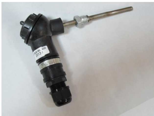
Рисунок 2 - Преобразователь в сборе с термопреобразователем сопротивления Пломбирование преобразователей измерительных ИМ2315 не предусмотрено.
