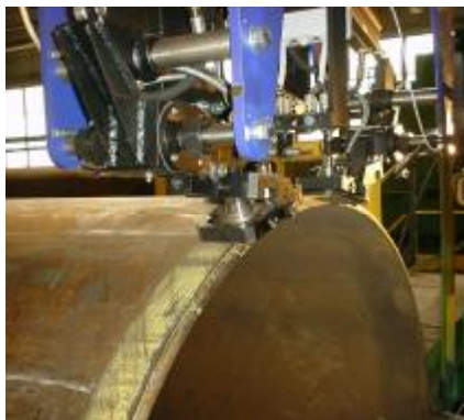
Рисунок 2. Система контроля основного металла концов труб.
