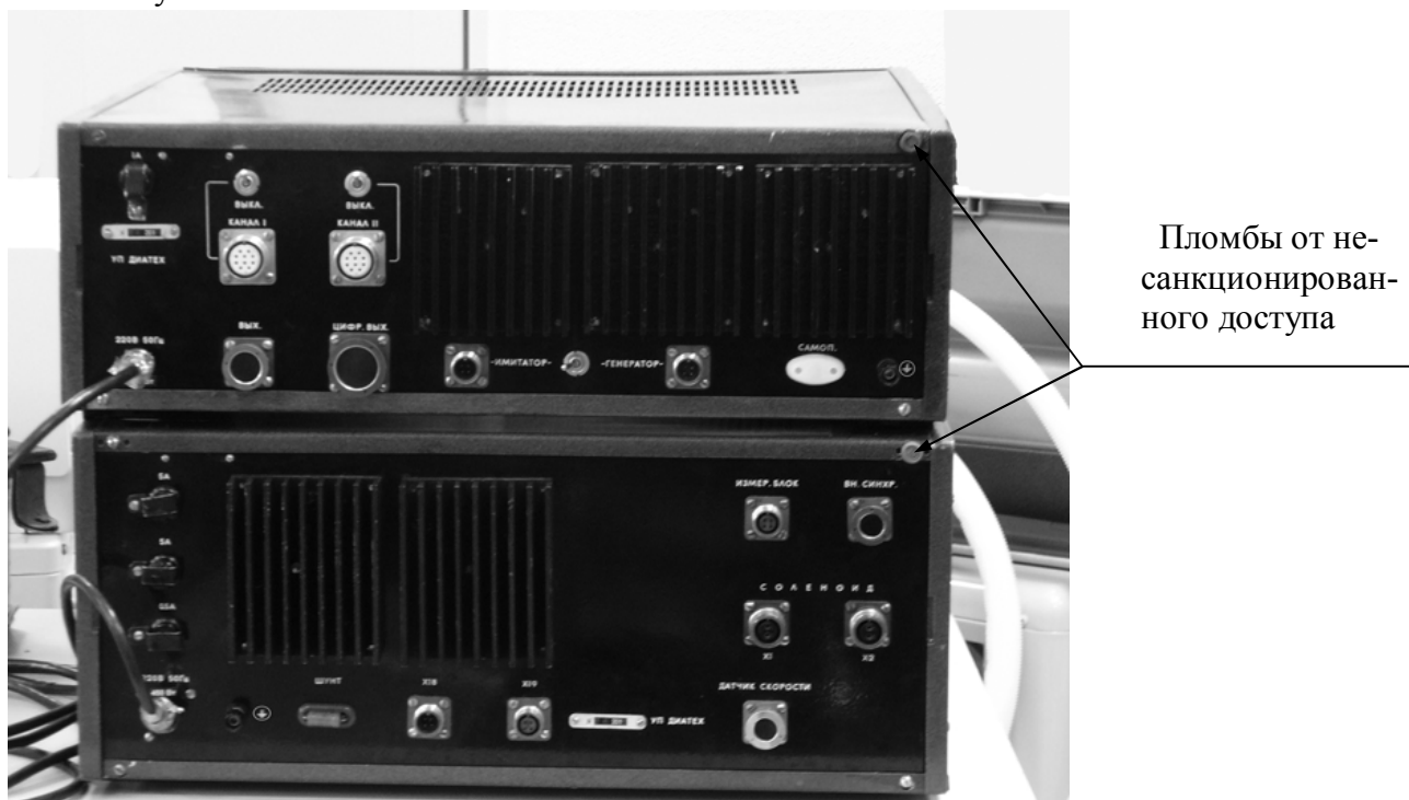
Рисунок 2 - Схема установки пломб от несанкционированного доступа
