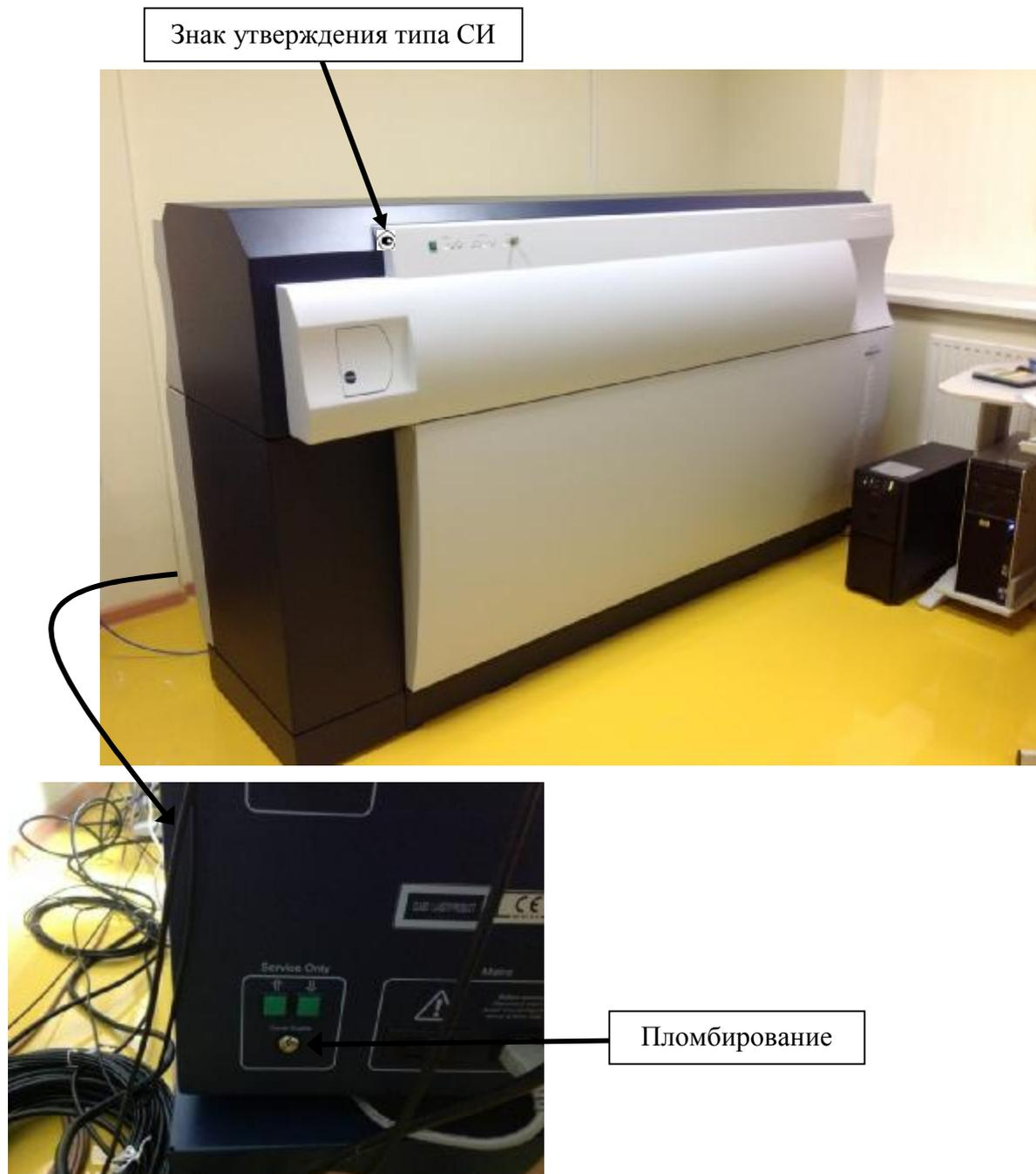
Рис. 1. Внешний вид масс-спектрометров Ultraflex
