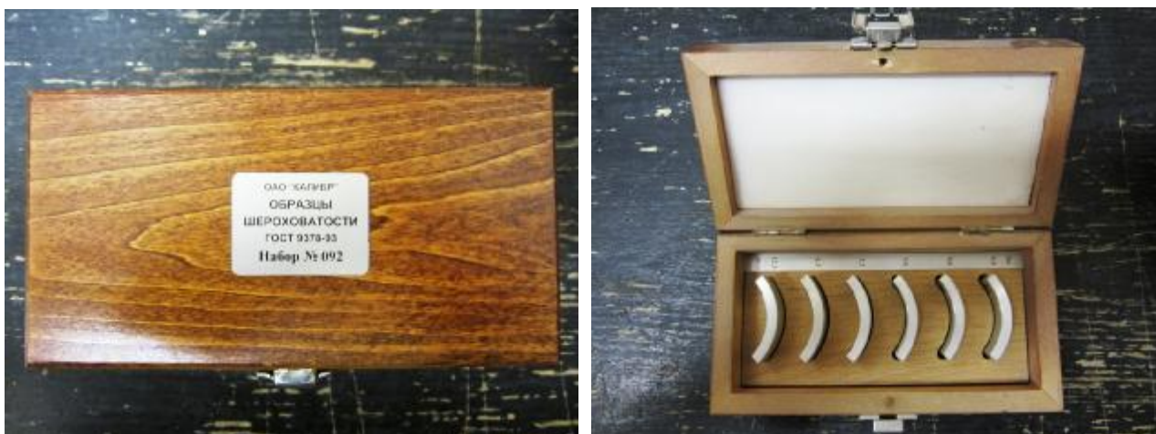
Рисунок 1 - Общий вид образцов шероховатости поверхности (сравнения) модель 1833
