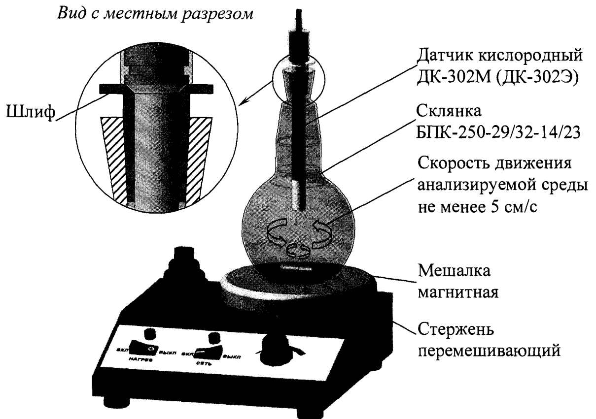
Рисунок 2.8 – Положение датчика ДК-302М (ДК-302Э) в склянке при измерении БПК
