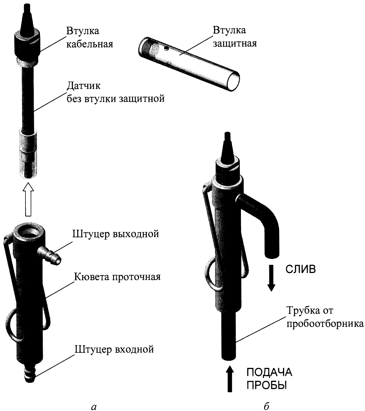
Рисунок 2.6 – Установка датчика кислородного ДК-302Т в кювету проточную
