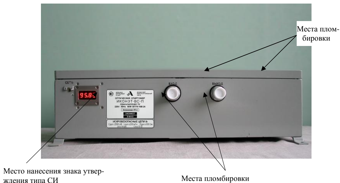
Рисунок 2 - Схема места нанесения знака утверждения типа и мест пломбирования спиртомера
