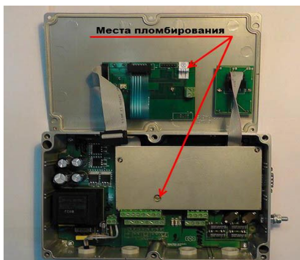
Рисунок 5 – Места пломбирования фальшпанели БЭП и переключателя режимов работы модуля индикации (для модификаций с ЖКИ)
