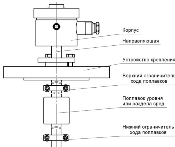
Рисунок 2 - Общий вид преобразователей ПМП-118, ПМП-062, ПМП-063, ПМП-076
