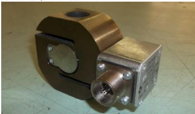
Рис. 1. Общий вид датчиков силоизмерительных тензорезисторных 4508 ДСТ
