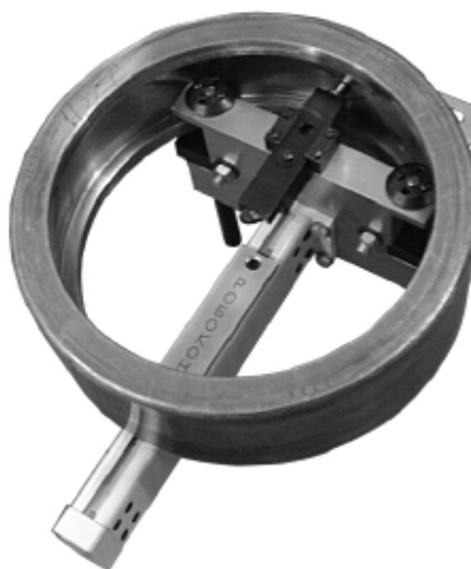
Рисунок 2- Измерительная позиция для наружных колец
