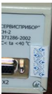
Рисунок 7 - Места пломбирования блока обработки влагомеров ВСН-2
