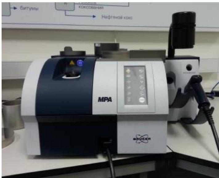
Рисунок 1. Общий вид Фурье-спектрометра МРА
