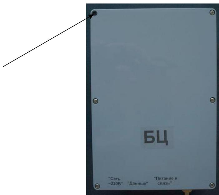
Рисунок 2 - Пломбирование БЦ комплекса МК-15
