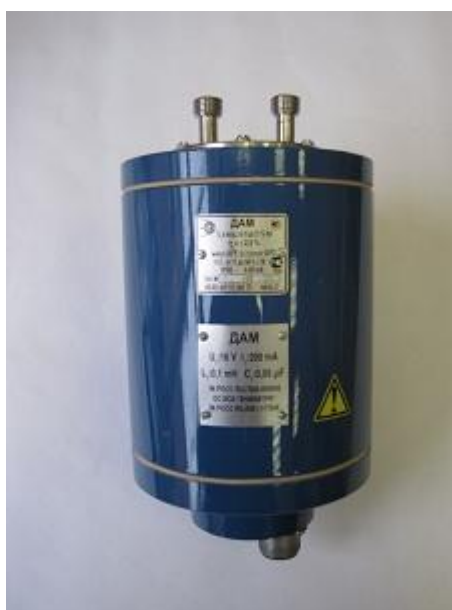
Рисунок 2. Внешний вид газоанализаторов с принудительным способом отбора пробы исполнения ИБЯЛ.407111.002-02...-49
