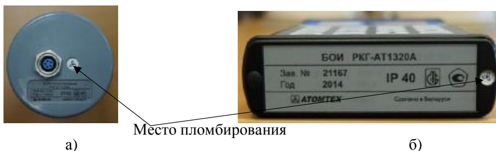
Рис. 2 Место пломбирования от несанкционированного доступа: а) блок детектирования, б) блок обработки информации
