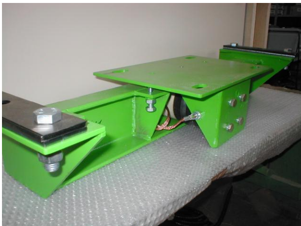
Рисунок 1 - Внешний вид грузоприёмного устройства весов
