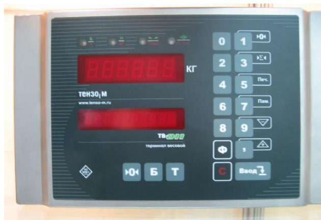
Рисунок 4 - Внешний вид весоизмерительного преобразователя ТВ
