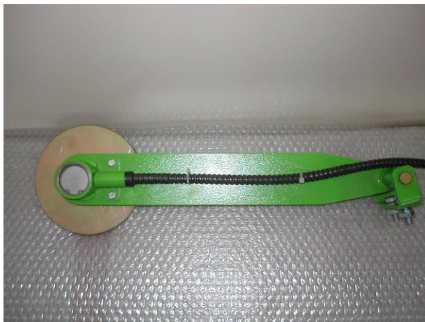
Рисунок 2 - Внешний вид датчика скорости
