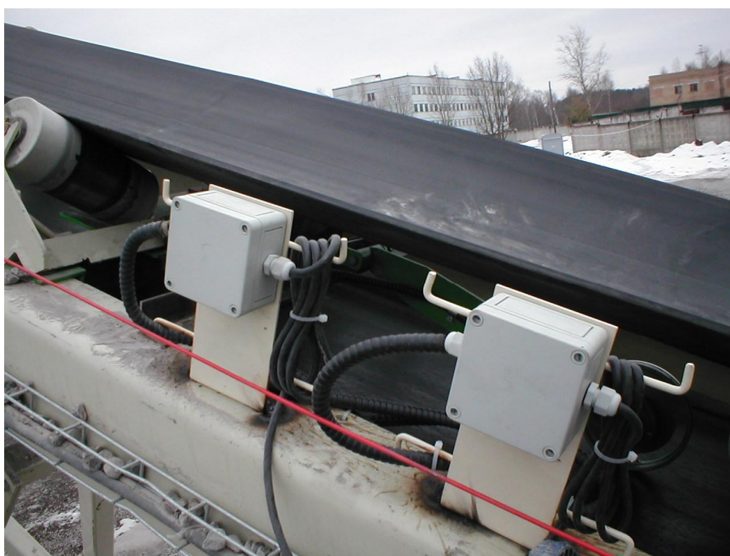
Рисунок 3 - Внешний вид весов ВНК, встроенных в конвейер
