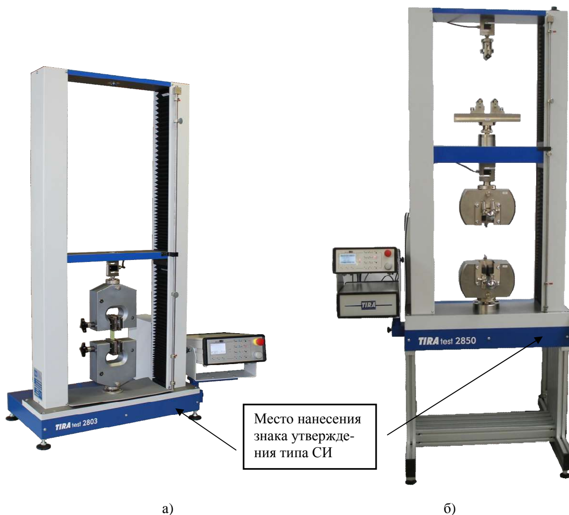
Рисунок 1 - Общий вид машин универсальных испытательных TIRAtest 2800 а) с одной зоной испытаний, б) с двумя зонами испытаний
