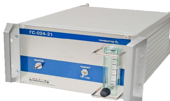
Рисунок 2 - Генераторы озона модификации ГС-024-21
