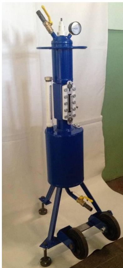
Рисунок 1 - Общий вид мерника металлического 2-го разряда для сжиженных газов ММСГ-1
