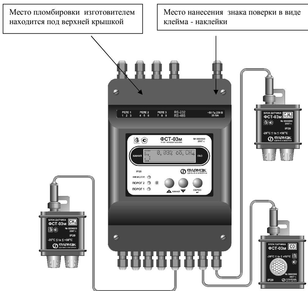
Рисунок 2- Схема пломбировки для защиты от несанкционированного доступа и обозначение мест для нанесения оттисков клейм
