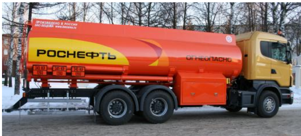
Общий вид автоцистерн БЦМ-83.7 модель 56471-05
