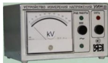
Устройство измерения напряжений УИН-20
