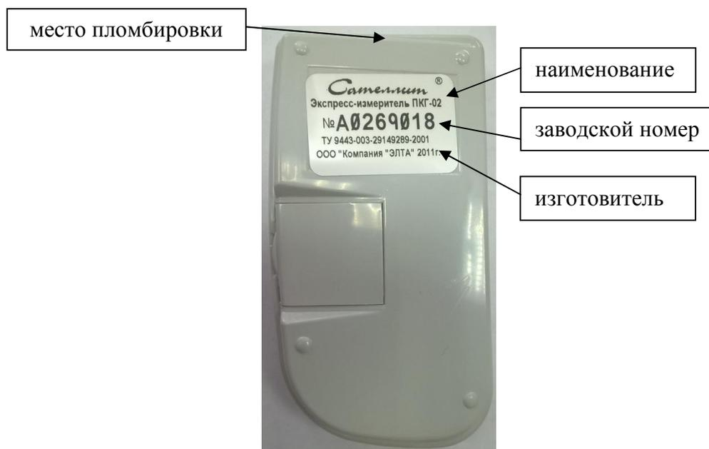
Рисунок 2 - Схемы пломбировки от несанкционированного доступа и маркировки
