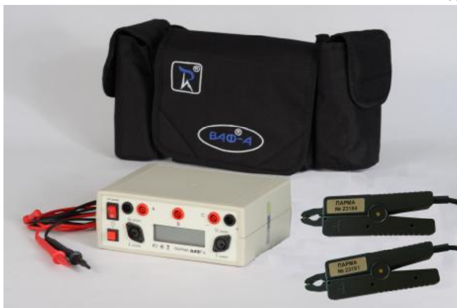
Рисунок 1 – Внешний вид вольтамперфазометров «ПАРМА В4Ф®-А» с принадлежностями
