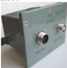
Рисунок 9 - Вторичные преобразователи ПОС, ПОР, ПОВ, ПТ и ПУ.
