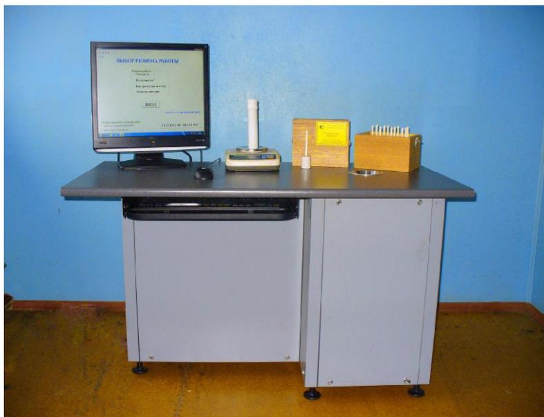
Рисунок 1 - Фото общего вида ЯМР-анализатора АМВ-1006М
