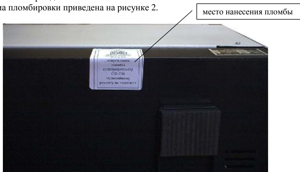
Рисунок 2 – Схема пломбировки спектрометра
