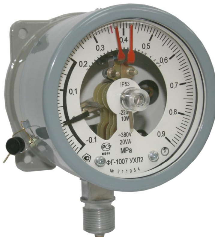
Рисунок 1 – Общий вид сигнализатора давления ФГ-2007
