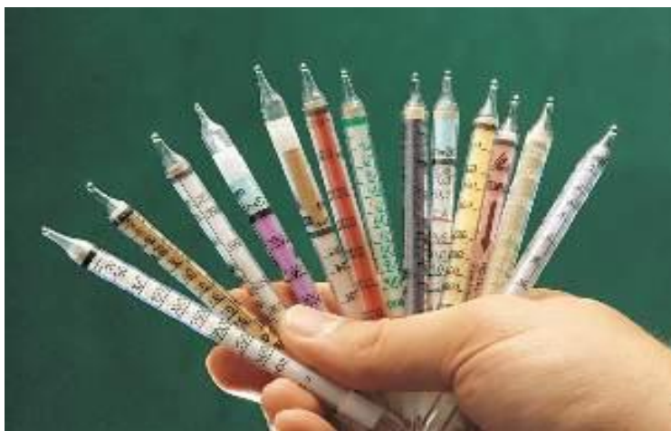
Рис. 1. Трубки индикаторные AUER, входящие в состав газоанализаторов.
