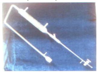
Трубка измерительная системы охлаждения представляет собой стеклянную трубку с разными диаметрами, при этом верхний конец большого диаметра впаян в систему охлаждения. На трубке меньшего диаметра нанесена шкала, а в нижней части имеется отвод и кран.
