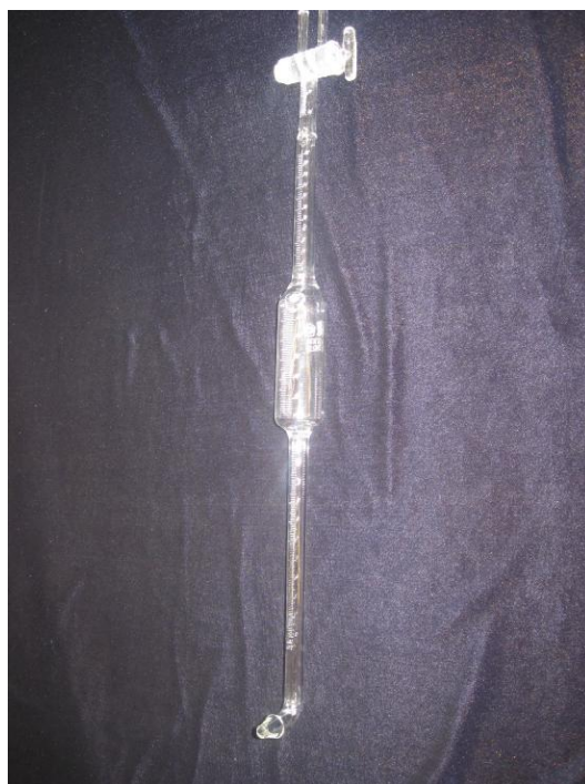
Рисунок 1 - Общий вид бюретки Гемпеля к газоанализатору ГК-1
