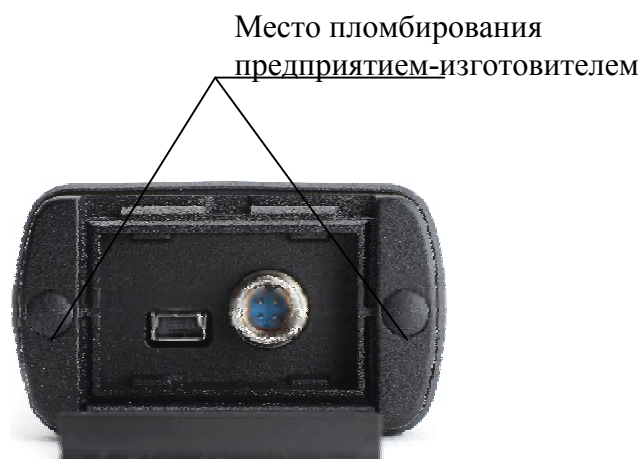
Рисунок 2 – Схема пломбировки от несанкционированного доступа
