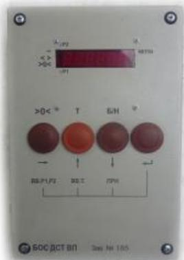
Рисунок 2 - Внешний вид блока весового БОС ДСТ ВП
