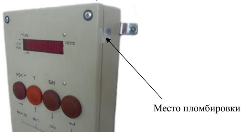
Рисунок 4 - Схема опломбирования блока весового БОС ДСТ ВП
