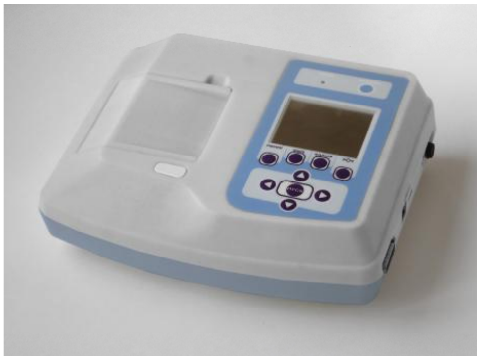
Рисунок 1- Электрокардиограф одно/трехканальный ЭК1Т-1/3-07 "АКСИОН"
