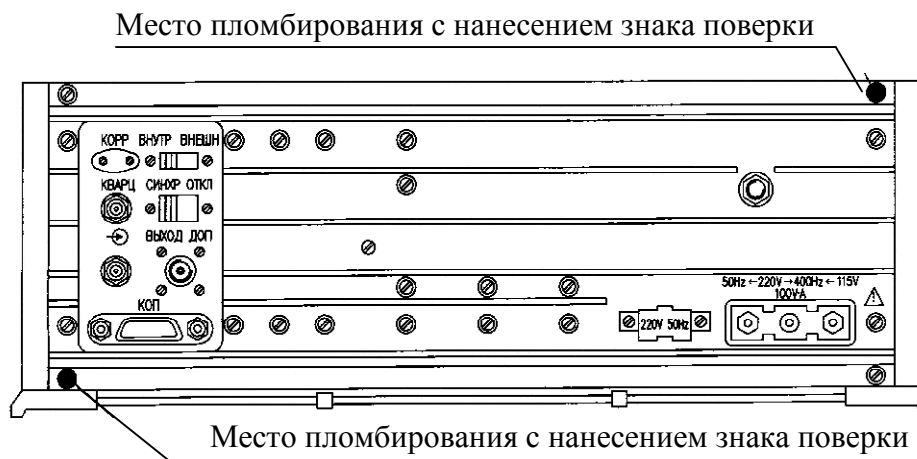
Рисунок 2 - Схема пломбировки от несанкционированного доступа, обозначение мест нанесения знака поверки
