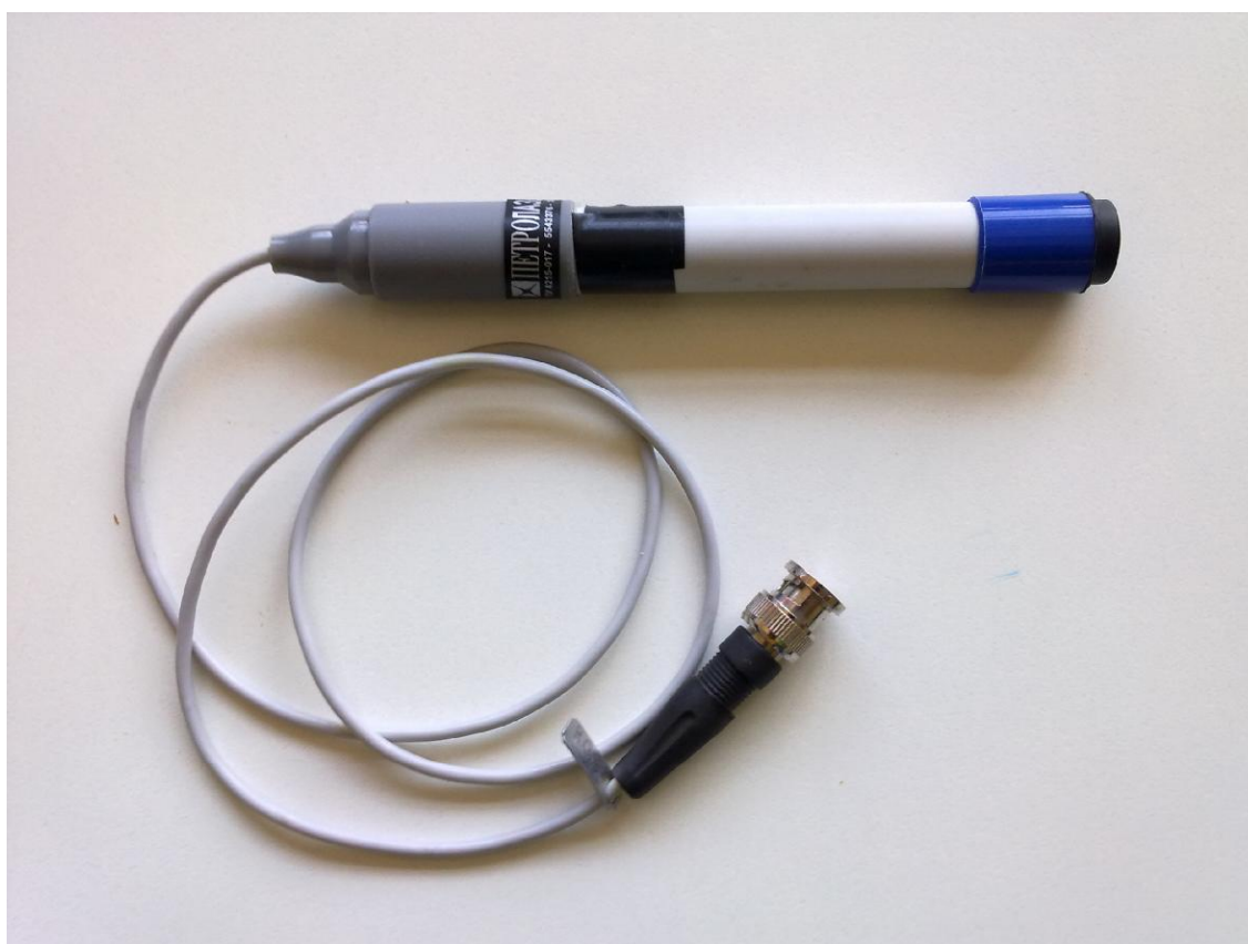
Рисунок 1 - Электрод нитрат-селективный мембранный комбинированный ЭМК-02
