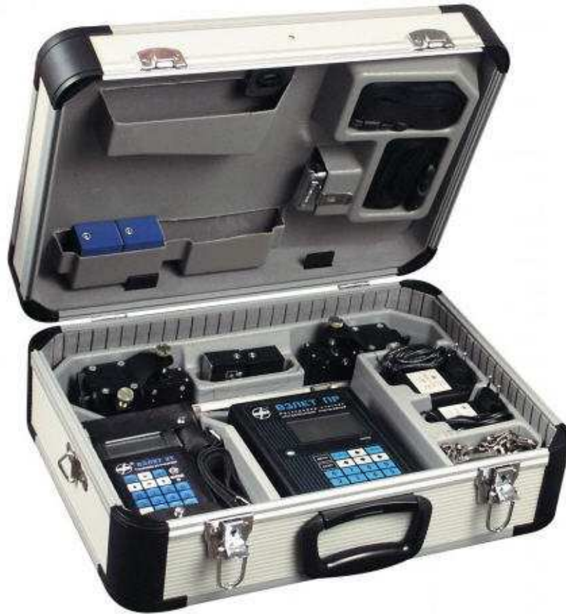
Рис.1. Общий вид расходомера-счетчика ультразвукового портативного УРСВ «ВЗЛЕТ ПР»
