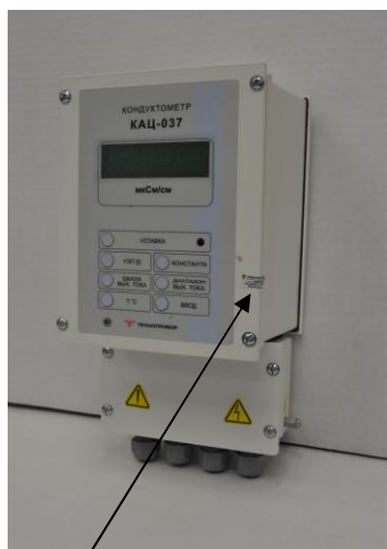
Место пломбирования Рисунок 1 - Кондуктометр КАЦ-037 настенный Пломбирование осуществляется пломбировочной наклейкой
