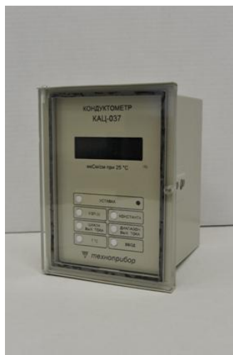
Место пломбирования Рисунок 2 - КАЦ-037 щитовой Пломбирование осуществляется пломбировочной пастой.
