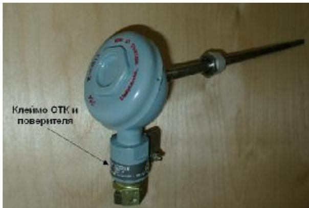
Рисунок 1 – Общий вид датчика температуры
